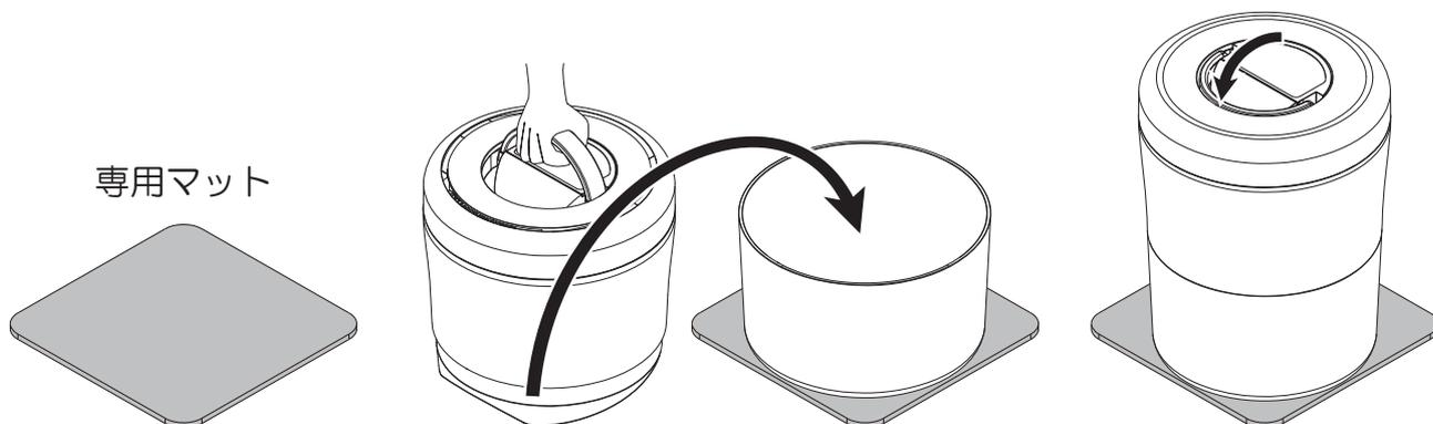
※取手が元の位置に戻っていない場合や、製品が傾いている場合、安全装置が作動するため運転を開始できません。取手を戻し、本体上部を真っ直ぐのせてください。
