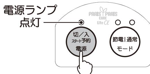
※電源が入ると、電源ボタンの上のランプが点灯します。
