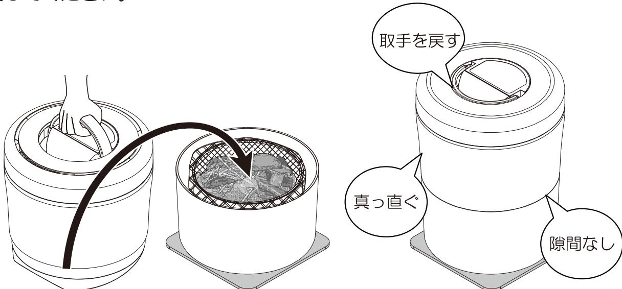
※取手が元の位置に戻っていない場合や、製品が傾いている場合、安全装置が作動するため運転を開始できません。取手を戻し、本体上部を真っ直ぐのせてください。
