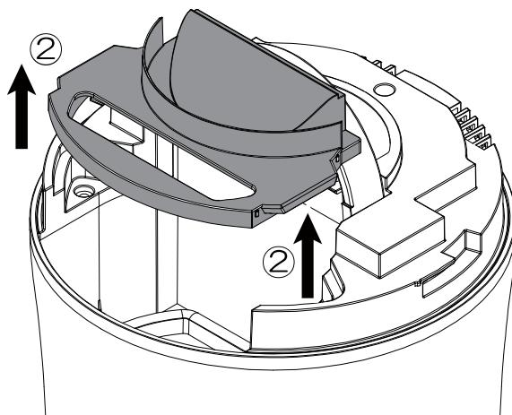
※取手を上げずにフィルターカバー小を外せば故障の原因となります。
