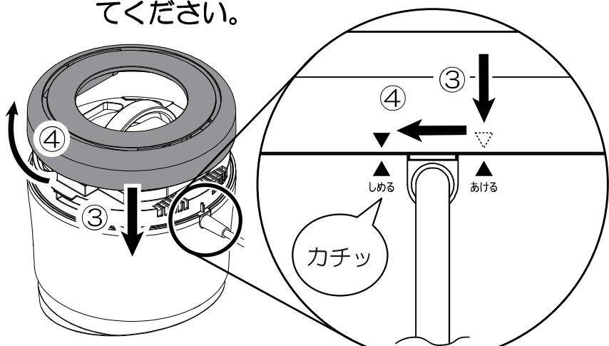
※共回りを防ぐために、本体上部、または取手を押さえながら、フィルターカバー大を回してください。必ず“しめる”の位置まで回してロックをしてください。
