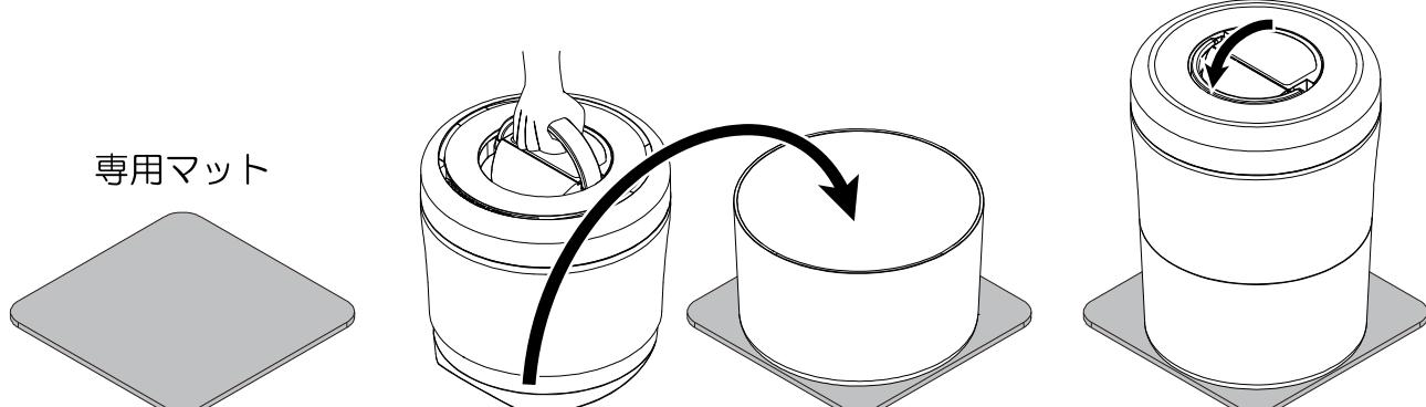
※取手が元の位置に戻っていない場合や、製品が傾いている場合、安全装置が作動するため運転を開始できません。取手を戻し、本体上部を真っ直ぐのせてください。
