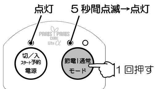
※電源ボタンを2回押すと、スタート予約（電源ランプ点滅）になり、すぐに運転が開始されません。電源ボタンを押し電源を切ってから、再度上記の操作を行ってください。
