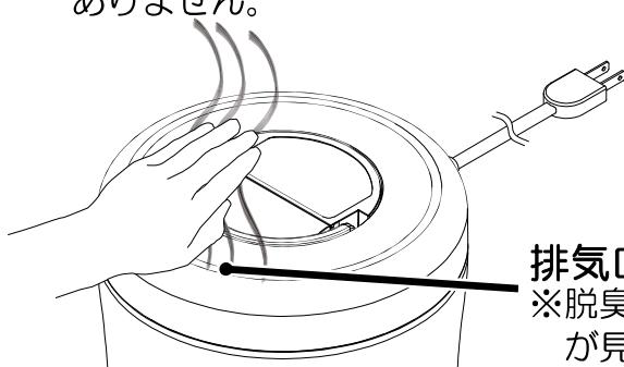
2. 温風確認後、電源ボタンを押して本体の電源を切り、試運転終了となります。これで生ごみ乾燥処理の準備が整いました。
