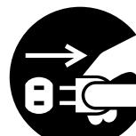
電源プラグを抜くときは、コードを引かずに、必ず電源プラグ部分を持って抜く。
