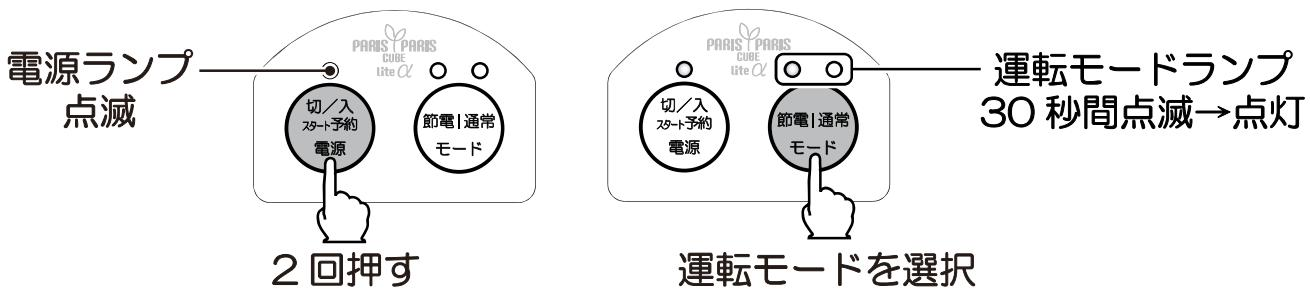
※電源ランプ点滅後、運転モードの選択が行われなかった場合は、自動的に電源が切れます。
